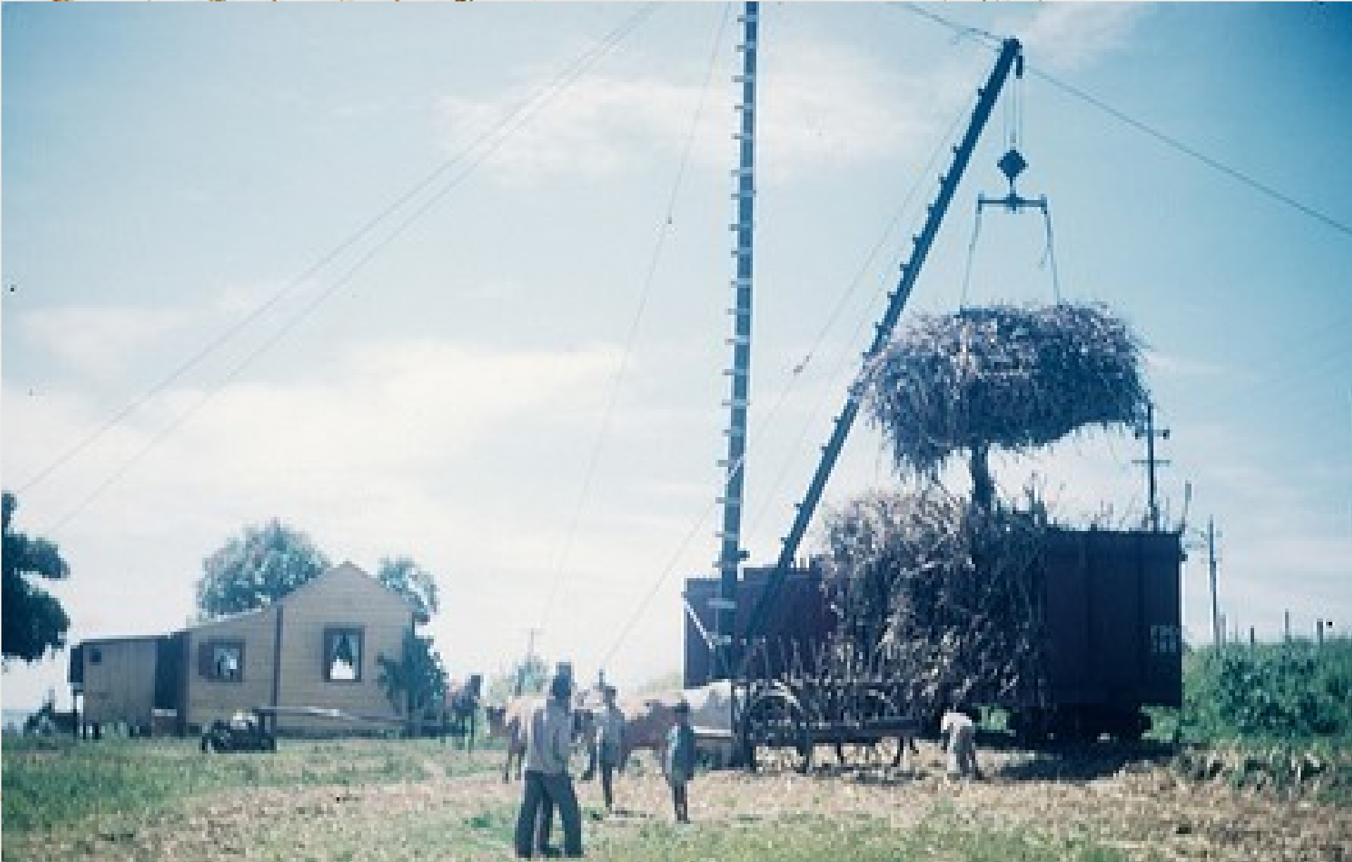
Transbordo de cañas de las típicas carretas a los vagones del ferrocarril.
